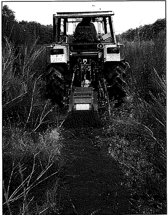
Une alternative à la préparation en plein, un broyage par bandes de quelques dizaines de centimètres de large à peine.
