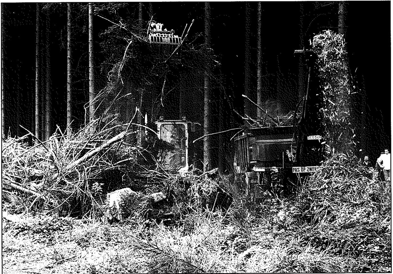
**A** l'opposé des broyeurs en plein qui attaquent les rémanents sur le sol même, il existe une autre série de machines nécessitant la manipulation manuelle ou par grappin des rémanents. Certaines d'entre elles se déplacent également sur la coupe mais uniquement dans le but d'atteindre les andains. Selon le principe de déchiquetage utilisé, les produits pourront éventuellement être valorisés en mulch, plaquettes de papeterie, etc.
