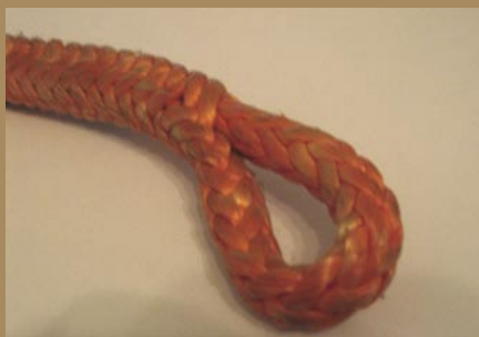
Épissure en œillet pour les terminaisons de ligne.
