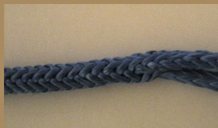
Épissure bout à bout pour réparer deux morceaux sectionnés.
