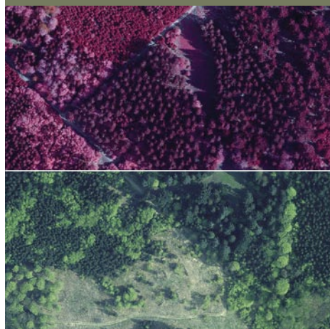
Figure 1 – Image aérienne en couleurs naturelles et en fausses couleurs infrarouges.
