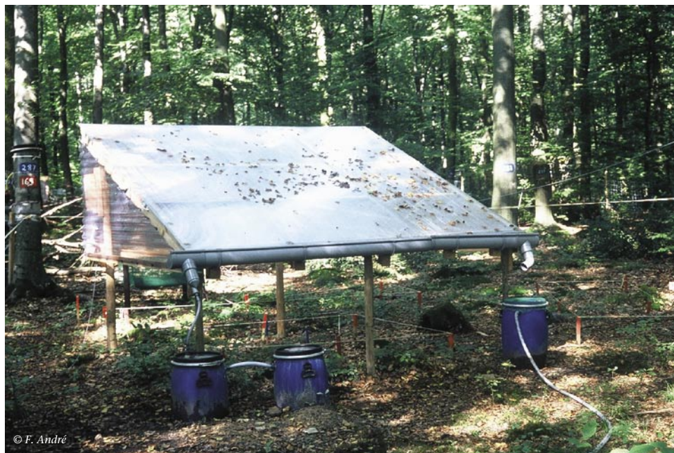
Toit collecteur des pluvioléssivats.
