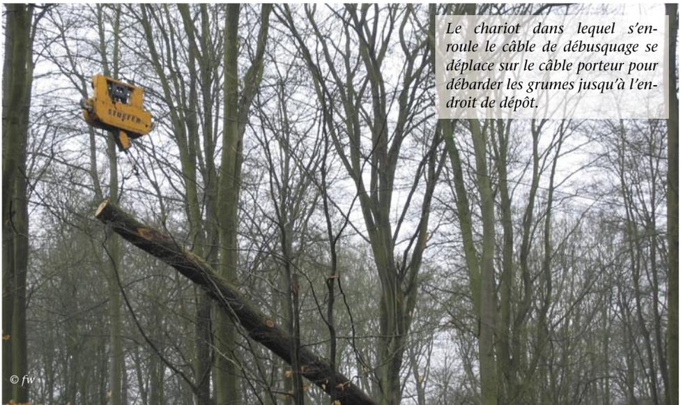
*Le chariot dans lequel s'enroule le câble de débusquage se déplace sur le câble porteur pour débarder les grumes jusqu'à l'endroit de dépôt.*
