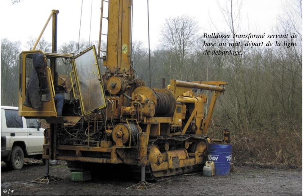
*Bulldozer transformé servant de base au mât, départ de la ligne de débardage.*
