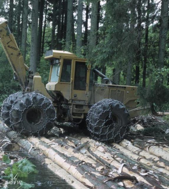
*Passage de la débusqueuse sur l'ouvrage. Les pneumatiques de l'engin sont équipés de chaînes pour éviter de glisser sur les billons.*
