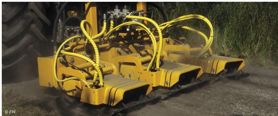
Photo 6 – Munie de trois patins indépendants, cette plaque vibrante permet un compactage qui respecte le profil dessiné par l'entrepreneur.
