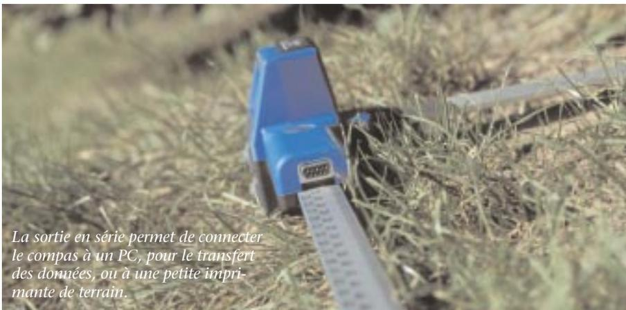
La sortie en série permet de connecter le compas à un PC, pour le transfert des données, ou à une petite imprimante de terrain.
