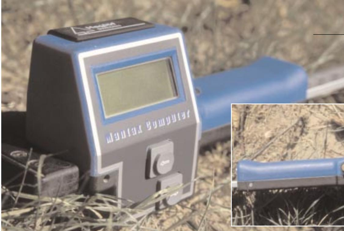
Faces avant et arrière du compas MANTAX. Les deux boutons avant permettent de circuler dans les menus, le bouton arrière de saisir les données.
