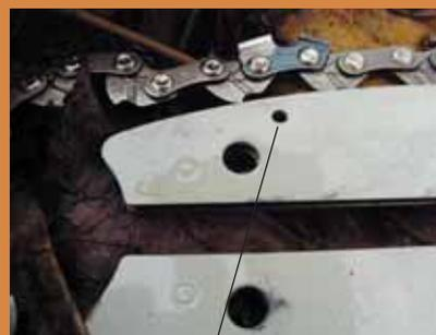
orifice d'arrivée d'huile dans le guide
