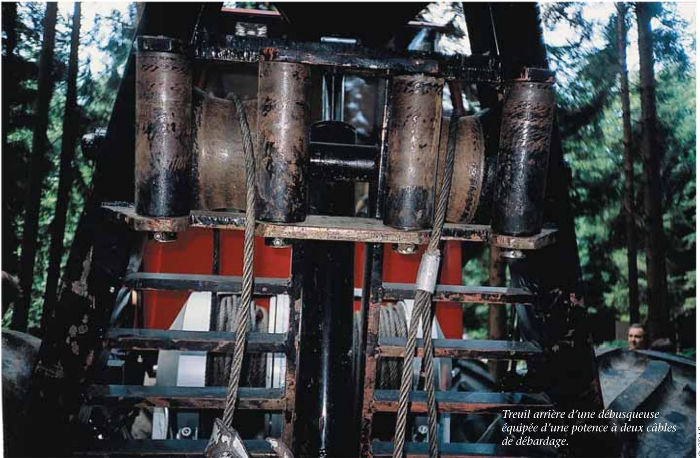
Treuil arrière d'une débusqueuse équipée d'une potence à deux câbles de débarbage.
