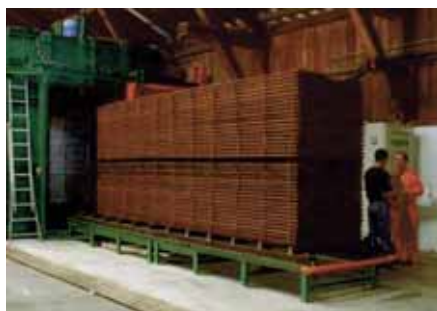
Premier four industriel d'une capacité de 8 m 3 permettant la rétifification du bois. Il est localisé à Soustons (dans les Landes) à environ 150 km de Bordeaux. Ce four a été racheté par la société HTT pour pouvoir entre autres en faire une plateforme d'essais et de formation. Il conserve toutefois son activité de production.
