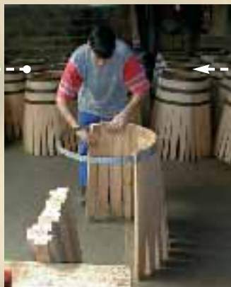
Les douelles sont placées dans le moule.
