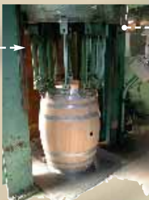
Mise en place des cercles définitifs.
