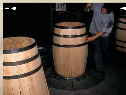
Opération de cintrage et mise en place, au marteau, des cercles provisoires.
