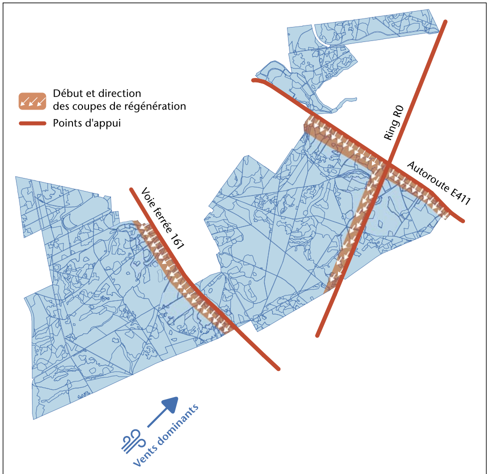
Figure 6 – Points d'appuis (potentiels) des coupes de régénération (lignes rouges).
