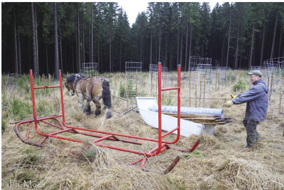
Figure 6 – Deux types de traîneaux : le premier pour le transport de bois de chauffage ou de grands matériaux (bobines de treillis...). Le second, à l'arrière-plan, pour du matériel plus petit (bornes, tronçonneuses, piquets, plants...).
