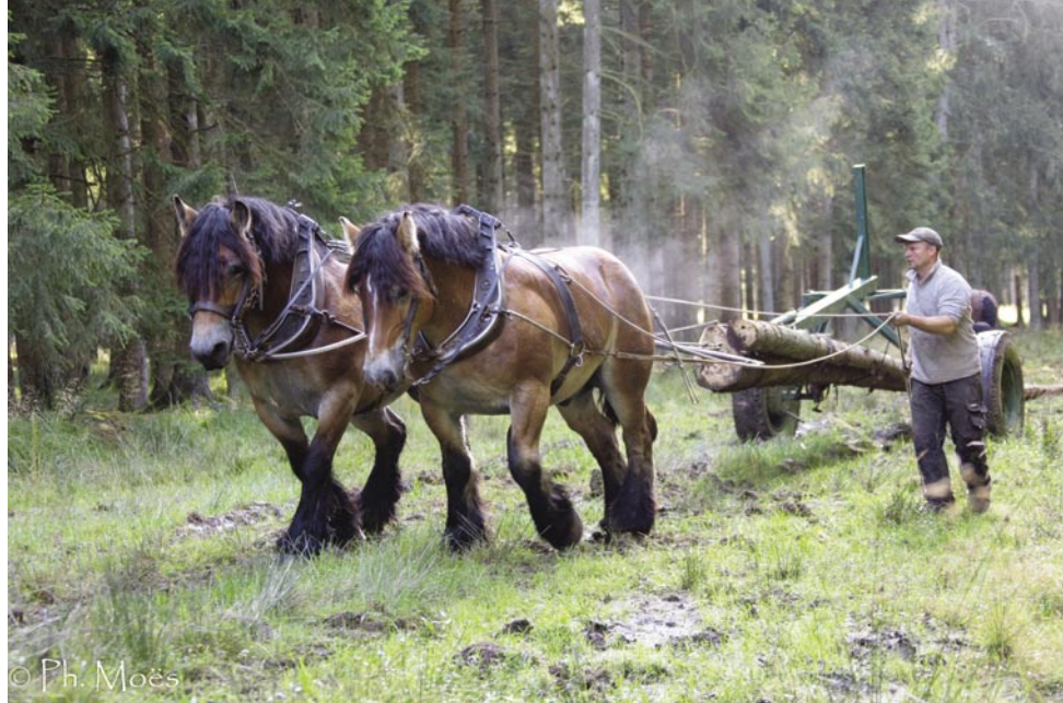
Figure 10 – Fardier ou triqueballe : dispositif muni de deux roues, permettant de soulever et porter l'avant de la charge disposée derrière le cheval ou les chevaux et, ainsi, d'en augmenter la masse potentiellement mobilisable (jusqu'à 4 m 3 ) et la distance de transport (jusqu'à 1 km).
