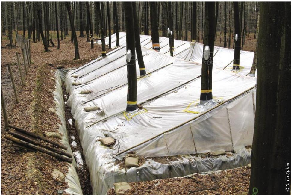
Figure 4 – Dispositif d'assèchement de deux parcelles de hêtre installé en forêt de Soignes de janvier 2009 à octobre 2010.
