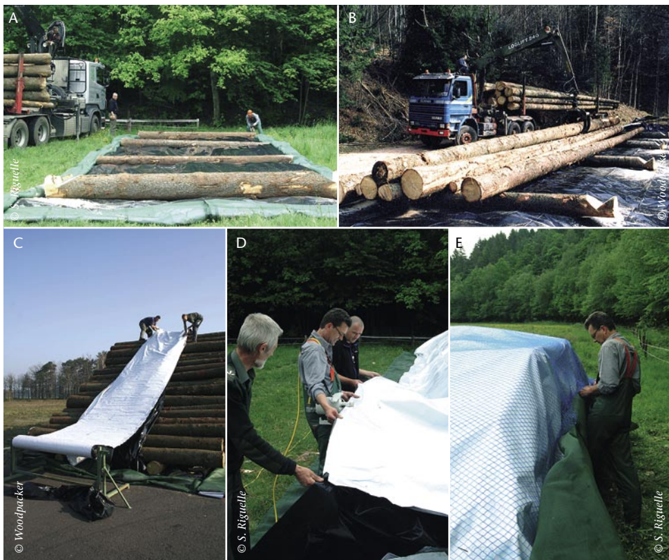
Mise en œuvre du stockage sous bâches hermétiques. (A) Pose du liner de sol, des bâches inférieures et des traverses. (B) Empilement des grumes ou des billons. (C) Pose des bâches supérieures. (D) Soudure thermique des bâches. (E) Pose du filet de protection et renforcement de la structure.
