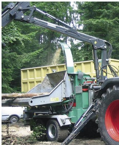
effet, les arbres étant broyés entiers, c'est l'ouverture du broyeur qui bloque ou non l'entrée de la matière. Les houppiers peuvent être recoupés par un bûcheron mais dans ce cas, le rendement diminue.
