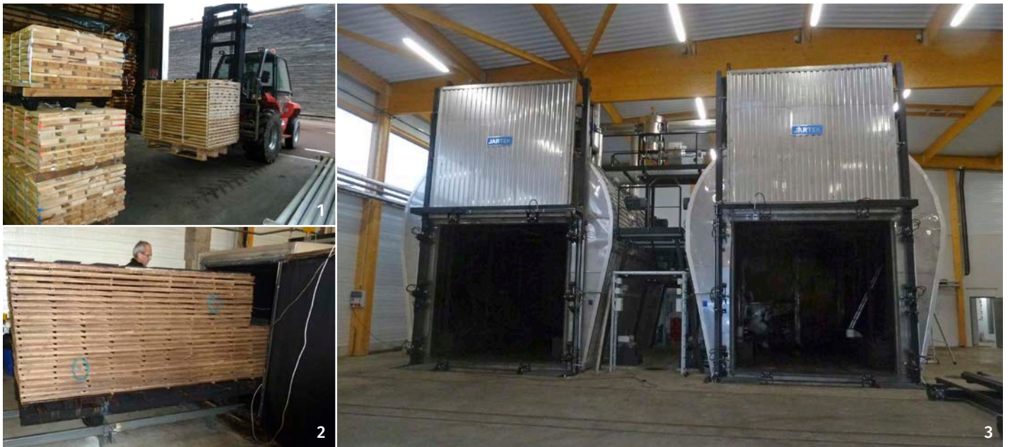
(1) Planches de bouleau avant traitement dans le four Jartek® à l'entreprise Bois durable de Bourgogne. (2 et 3) Traitement des planches de bouleau dans le four Jartek® (1 m 3 ) et les deux grands autres fours Jartek® de 20 m 3 de l'entreprise Bois durable de Bourgogne.
