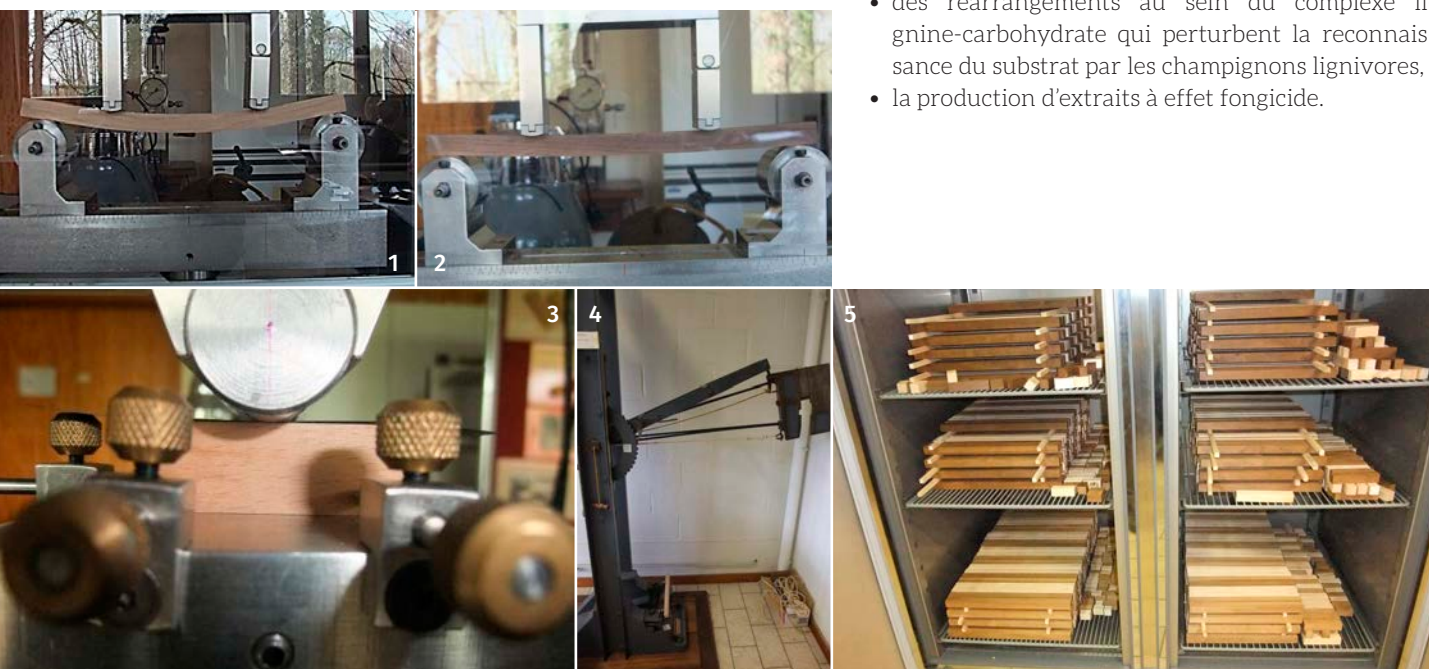
Éprouvette de chêne Blanco (1) et Traité (2) juste avant la rupture en flexion statique. Essai de dureté (3). Essais de résistance à la rupture en flexion dynamique (choc) (4). Éprouvettes de bouleau Blanco et Traité destinées aux essais mécaniques (5).
