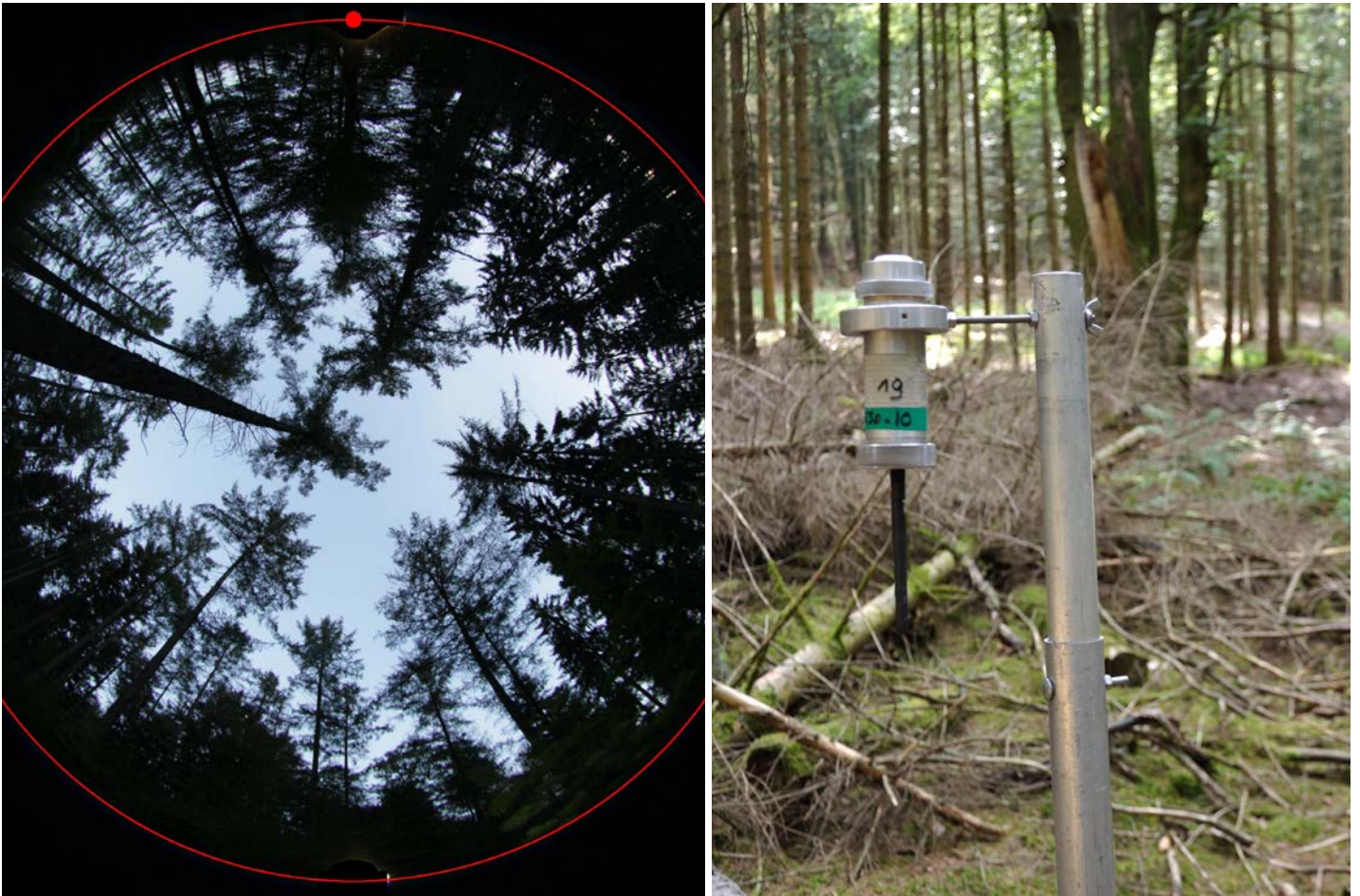
Figure 4. Illustration d'une photographie hémisphérique (à gauche) et d'un capteur photosensible (à droite) utilisés pour quantifier l'éclairement relatif dans le sous-bois.
