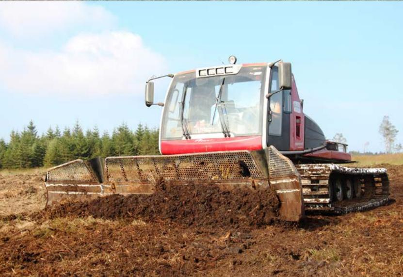
Fraisage : broyage de la végétation (au-dessus) et raclage du broyat avec une machine du type dameuse de piste de ski (en dessous).
