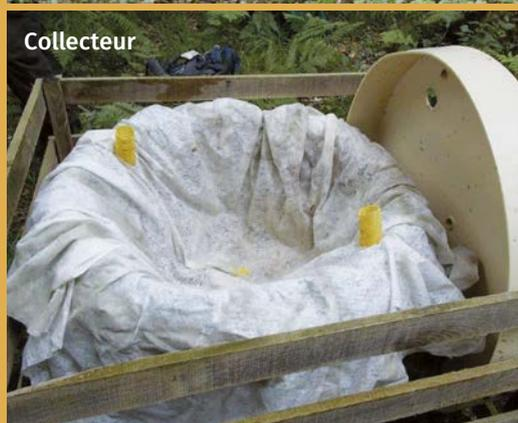
Dispositif d'échantillonnage de collecte de fleurs et fruits des chênes suivis par le LBBE et l'ONF.
