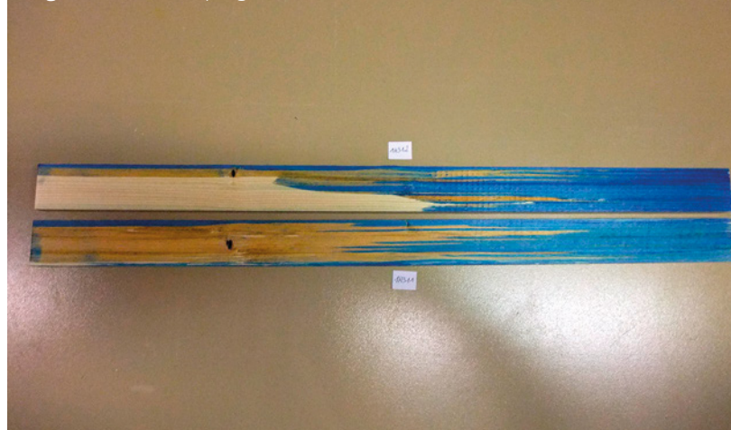
Figure 6. Test d'imprégnation des bois.
