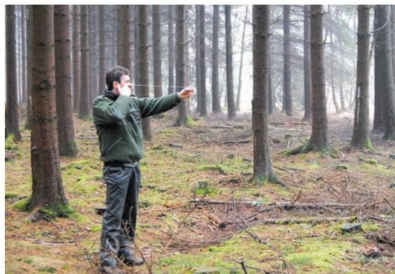
Mesure de la surface terrière avec un relascope à encoches (Beuraing).
